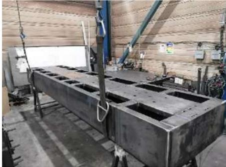
La fabrication du **socle en structure acier lourd** garantie une rigidité et une stabilité de l'ensemble.
