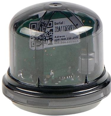
**TZX** est un nœud intelligent (soit un point de connexion) pour la gestion de l'éclairage public. Il s'installe sur lanterne standardisée avec connectique Zhaga et il permet de piloter et de surveiller à distance un point lumineux.
